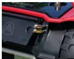
Czujnik deszczu, który może być wyłączony
